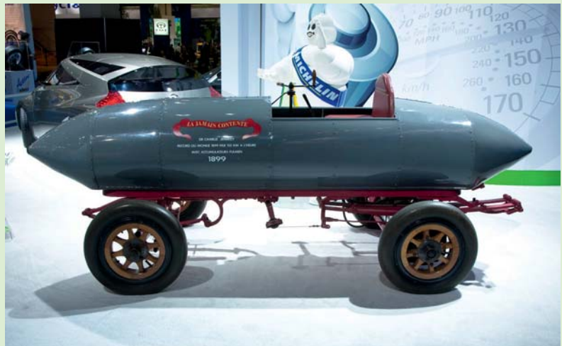
De eerste auto die sneller dan 100 km/u reed in 1899 van de Belg Camille Jenatzy. De auto is elektrisch aangedreven
